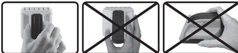
En maintenant le bouton enfoncé, les LED s'allumeront rapidement vers le centre, indiquant que l'unité est allumée. Vous pouvez appuyer sur le bouton lorsque l'appareil est en contact avec le mur ou pas. Aucun étalonnage n'est nécessaire. Au fur et à mesure du balayage, les DEL s'allument pour indiquer l'emplacement de tout objet caché.
