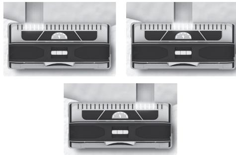
**Leitungsspannungsmesser:** Wenn eine stromführende Leitung erkannt wird, leuchten die gelben LEDs auf dem Leitungsspannungsmesser (Patent angemeldet) der Reihe nach auf, wenn die elektrische Spannung zunimmt.
